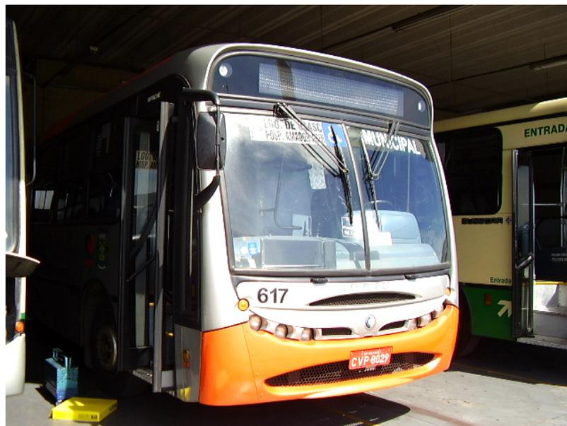
**Figura 17.:** Ônibus escolhido para determinação do espectro de solicitações – MB OF1722.
