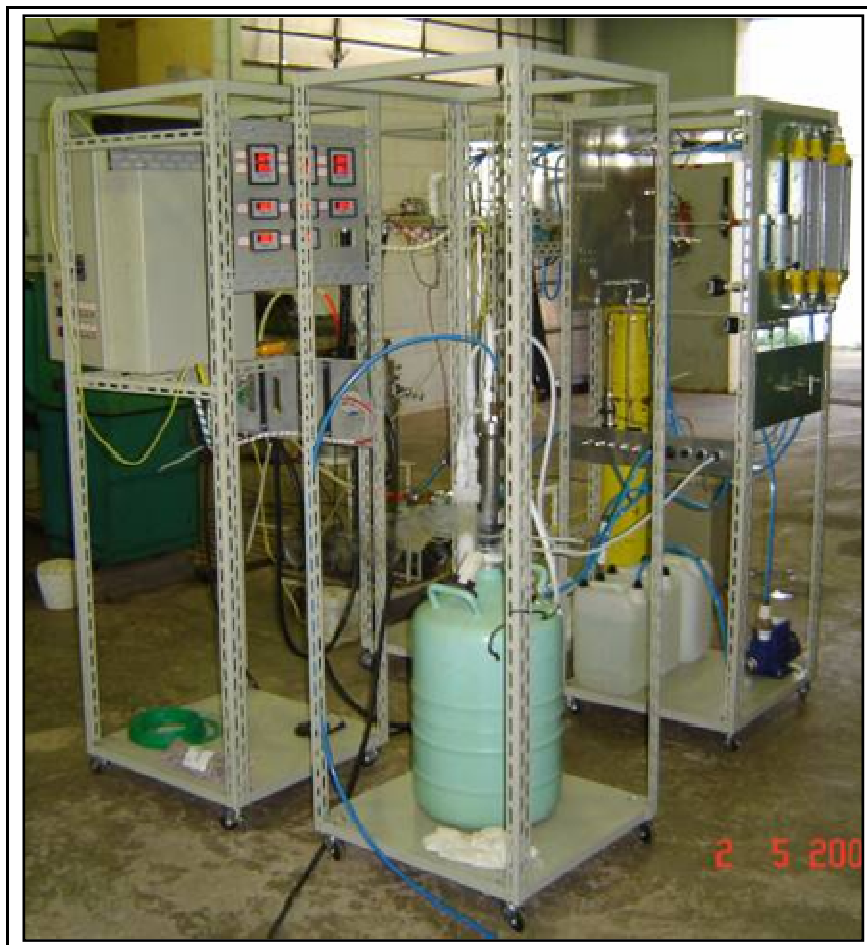
Figura 3.24 – Módulo elétrico/eletrônico (a esquerda), dewar de nitrogênio líquido (purificação do ar de entrada), módulo de medição de vazão (a direita). Fonte: Elaboração Própria.
