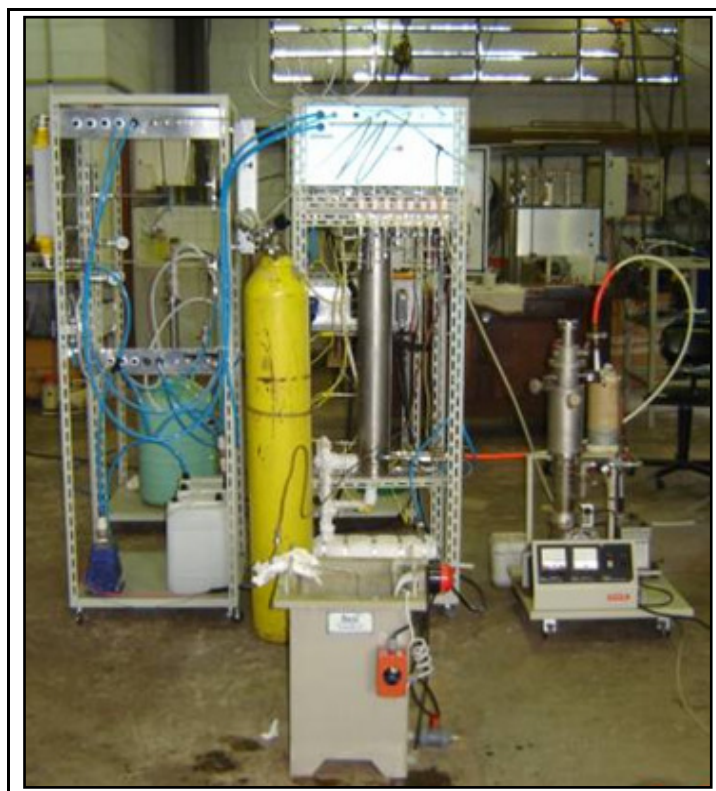
Figura 3.23 – Módulo de medição de vazão (à esquerda), módulo de purificação (ao centro). Fonte: Elaboração Própria.
