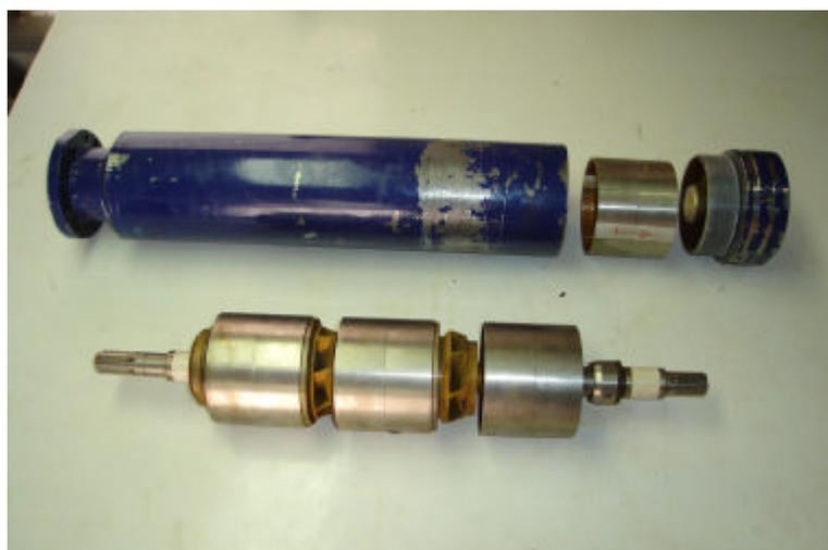
Figura IV.3 – Retirada do eixo com os internos da BCS GN-7000.
