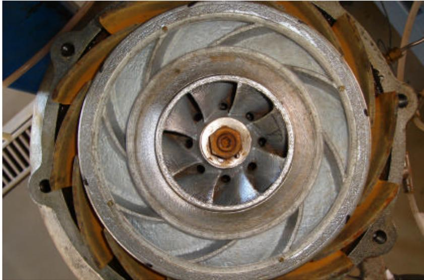
Figura V.7 - Bomba Imbil ITA 65-330/2 - Vista do 1º rotor com janela de acrílico.
