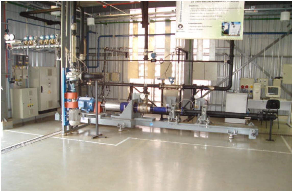
Figura 3.1 - Vista geral da montagem do Sistema de Testes de Bombas Centrífugas.
