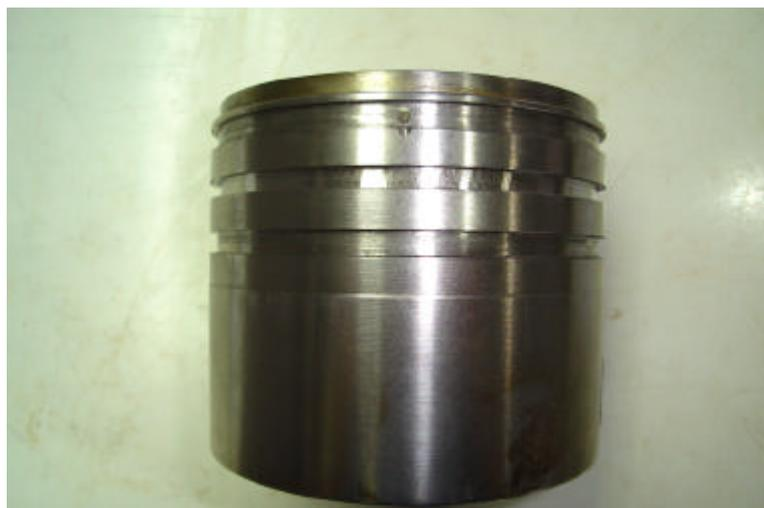
Figura IV.6 – 1º difusor: furo e os canais de comunicação de pressão e o’ring.
