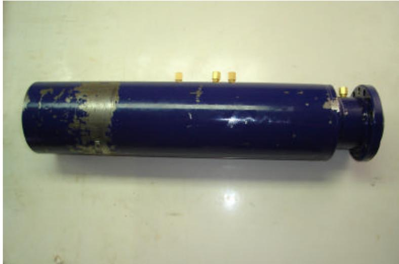
Figura IV.12 – Pontos de tomada de pressão na carcaça tubular da BCS.
