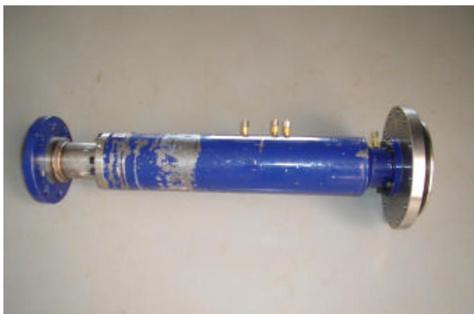
Figura IV.15 – BCS GN-7000 montada com os pontos de tomada de pressão.
