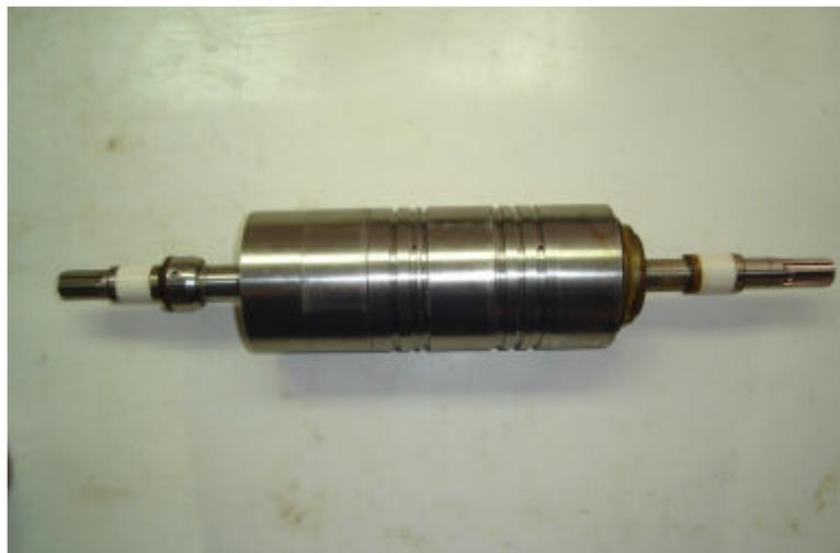
Figura IV.13 – Difusores e rotores montados no eixo da BCS.
