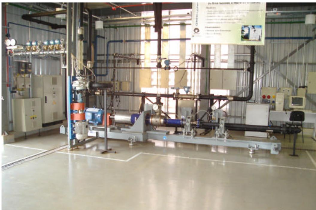
Figura V.1 - Vista geral da montagem do Sistema de Testes de Bombas Centrífugas.
