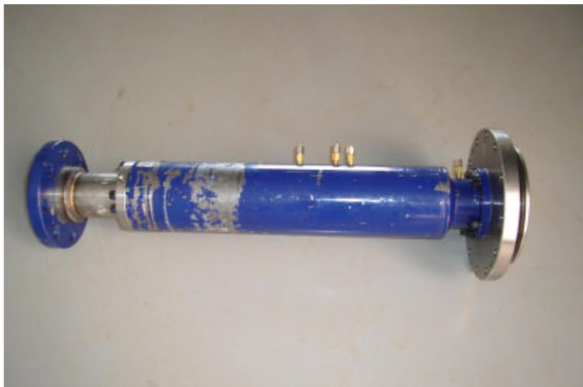
Figura V.4 - BCS GN-7000 com as tomadas de pressão.
