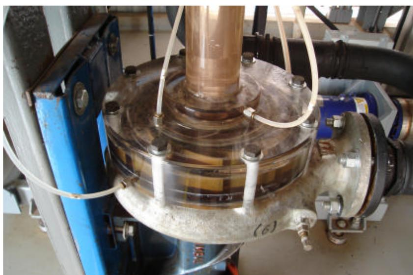
Figura V.6 - Bomba Imbil ITA 65-330/2 – Montada com a tampa de acrílico.
