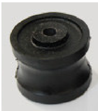
Fig. 4.38 – Amortecedor de vibrações utilizado no ensaio experimental e simulação numérica.
