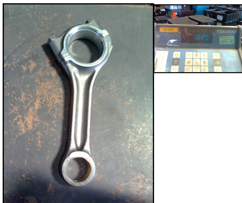
Fig. 4.4 – Medição manual de massa da biela, bucha e bronzina.
