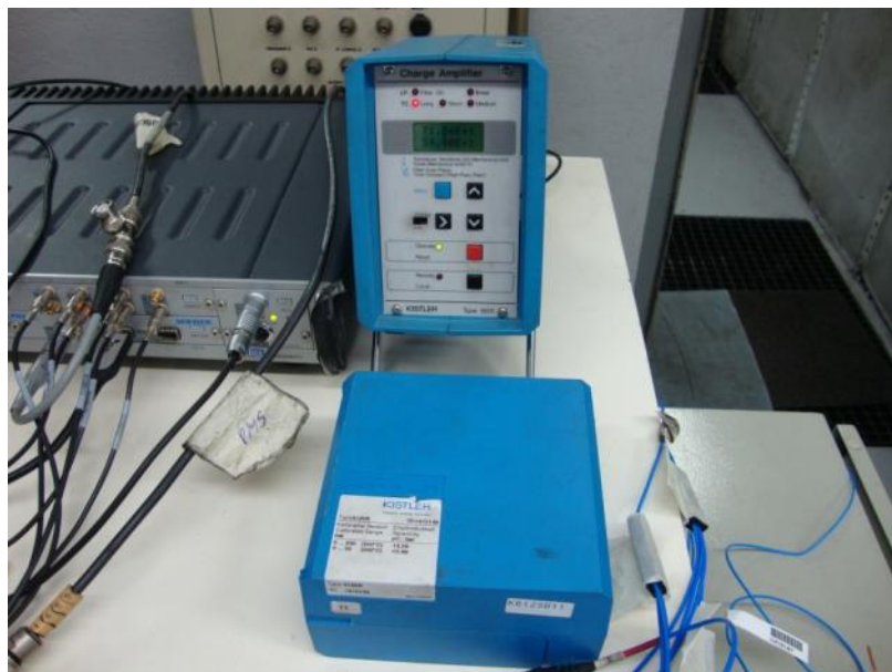
Fig. 4.14 – Amplificador de sinal vindo do transdutor de pressão
