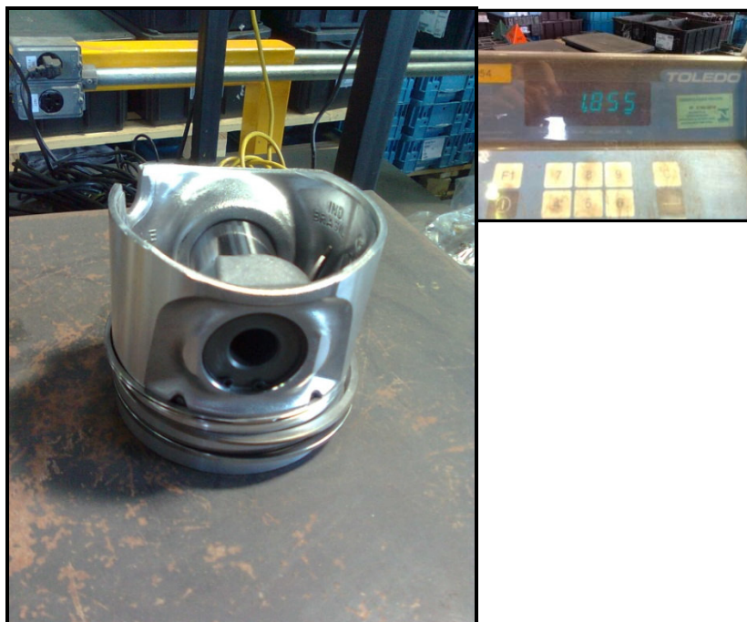
Fig. 4.3 – Medição manual de massa do pistão, pino e anéis.
