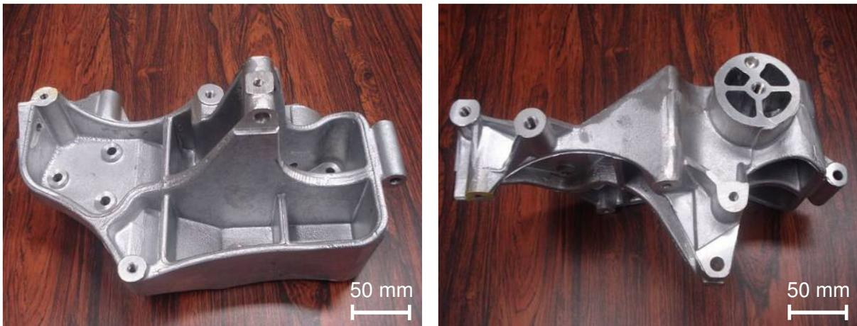
Fig. 3.2 Suporte de acessórios de motor a diesel produzido na liga Al-Si5-Cu3-Mg.
