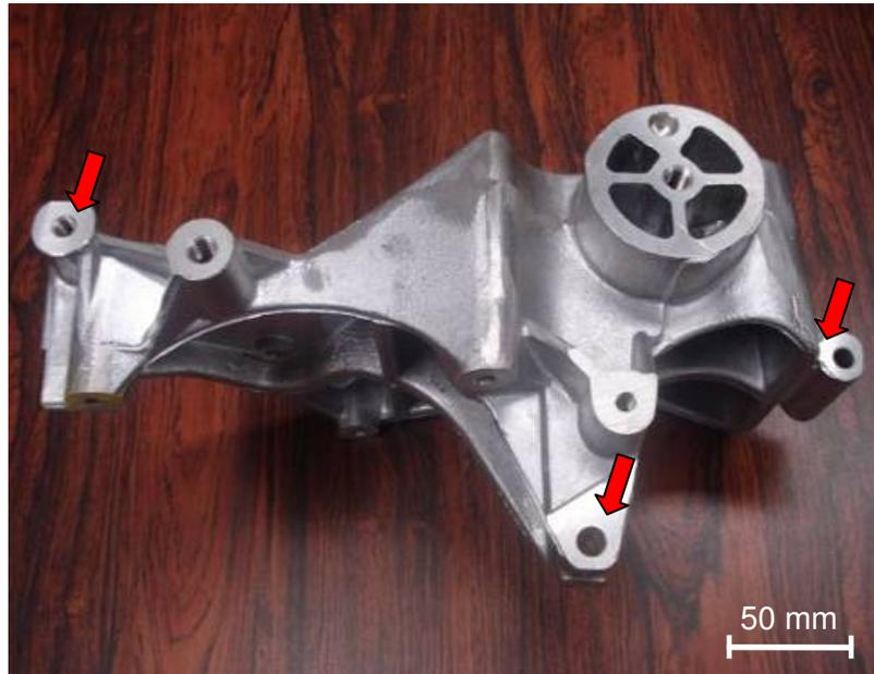
Fig. 3.7 Indicação de posição de retirada de amostras para análise de microestrutura do componente comercial fundido.
