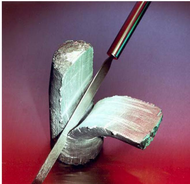
Fig. 2.1 Lingote de alumínio no estado semi-sólido (adaptado de VINARCIK, 2002)
