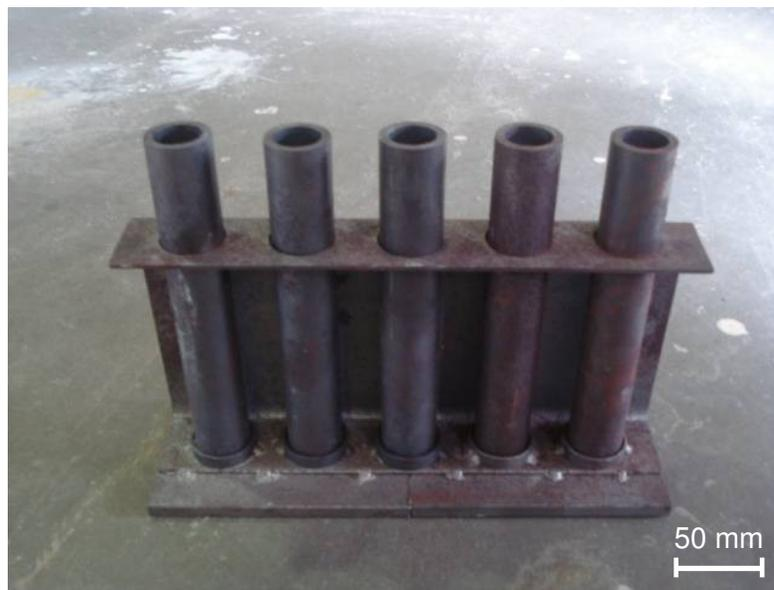
Fig. 3.3 Lingoteiras utilizadas para a produção das amostras fundidas da liga Al-Si5-Cu3-Mg
