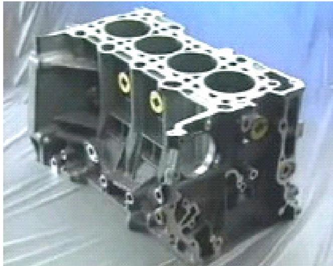
Fig. 1.3 Bloco de motor a diesel do veículo Honda Accord produzido utilizando a tecnologia de semi-sólidos (MASAKASU *et all*, 2004)
