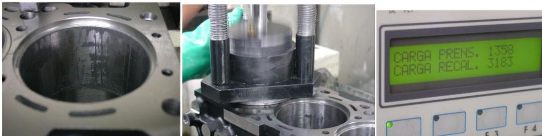
Figura 30 – Detalhes da aplicação do bissulfeto e prensagem da camisa no bloco
