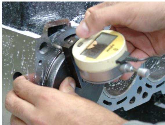
Figura 31 – Detalhes da medição da altura das camisas
