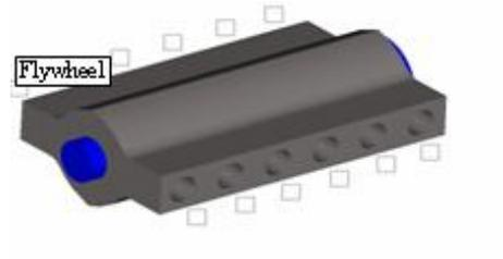
Figura 14 – Disposição de cilindros opostos
