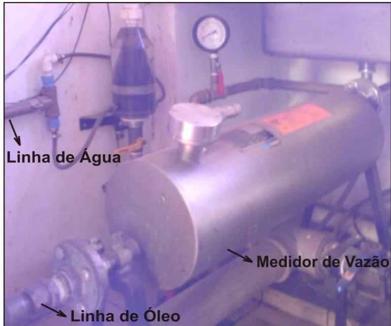
Figura 3.3: Medidor de Vazão de óleo.
