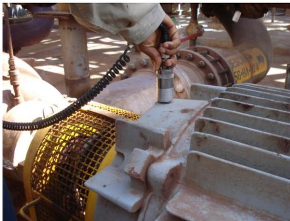
Figura 3.6: Medição do sinal de vibração com a ferramenta *half spectrum*.
