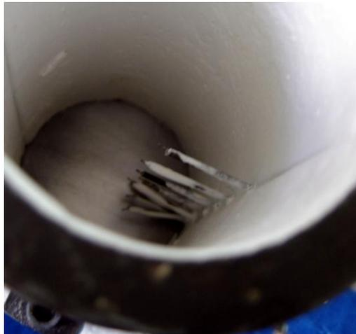
**Figura 4.11 - Vista de topo da lingoteira montada mostrando o posicionamento dos termopares**
