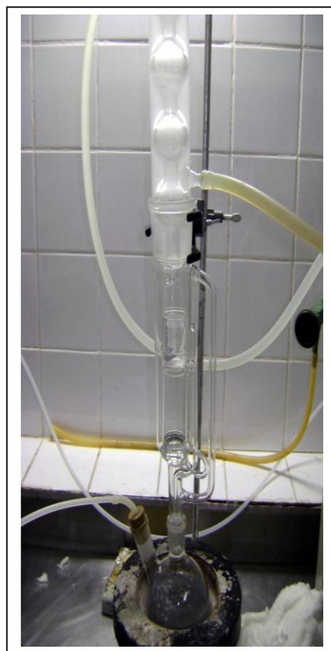
**Figura 4.16 - Dispositivo utilizado para dissolução de alumínio em 1-butanol –esquema e foto**
