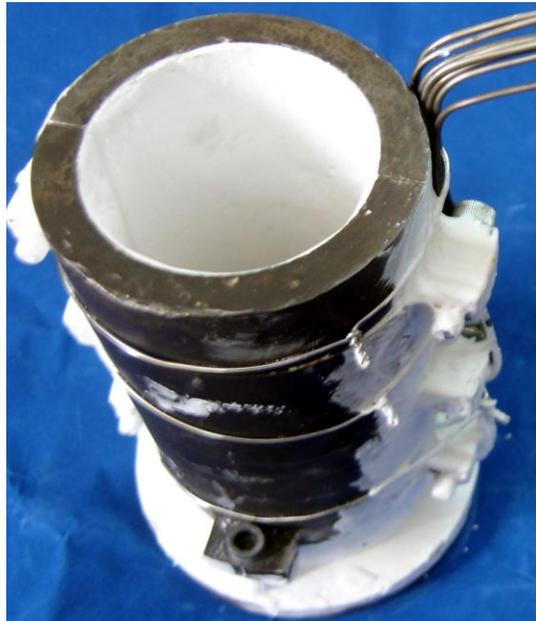
**Figura 4.7 – Lingoteira preparada para o experimento**
