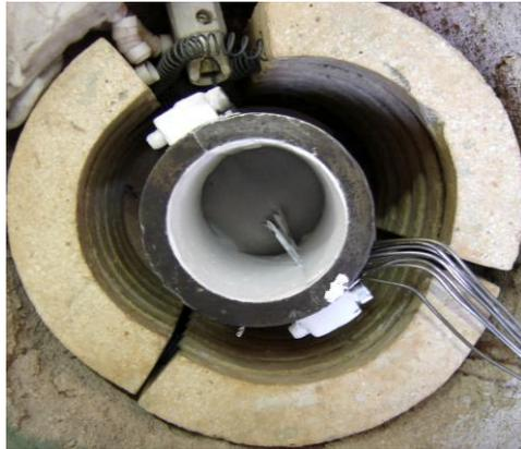
**Figura 4.8 – Montagem da Lingoteira no Dispositivo de Solidificação**
