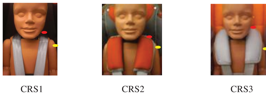
Figura 4.12. Pontos digitalizados para avaliar o posicionamento das tiras de ombro. O ponto vermelho representa o slot e o ponto amarelo representa a articulação do ombro do dummy .
