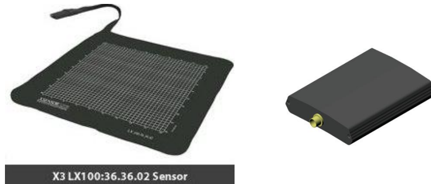
Figura 3.12. X-Sensor mostrando a manta flexível e porta de entrada para o software .
