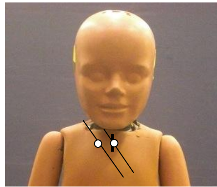
Figura 3.10. Situações de passagem da tira de torso (os pontos brancos indicam as bordas medial e lateral da tira de torso). À esquerda, a tira passa mais lateralmente ao osso manúbrio. À direita, a tira passa sobre o osso manúbrio compreendendo a base do pescoço.
