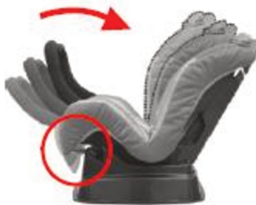
Figura 3.13. Ângulos de inclinação do assento infantil, sendo 0° o ângulo mais vertical e 40°, o ângulo mais inclinado.
