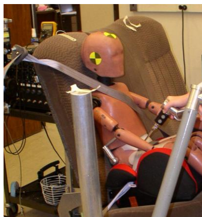
Figura 3.6. Digitalização do ponto onde a tira abdominal passa pelo abdômen do dummy .
