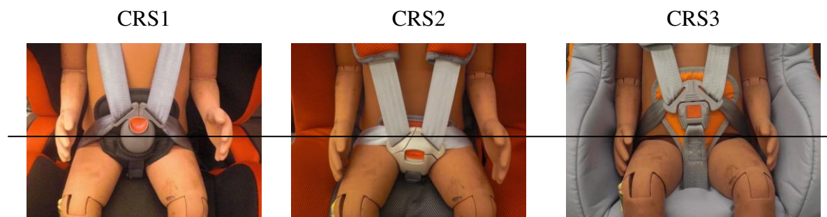
Figura 4.15. Posicionamento do fecho do cinto nos modelos de assentos testados. A linha preta foi traçada na altura da articulação do quadril do ATD.
