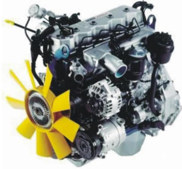
**Figura 28:** Motor MWM Sprint 4.07 TCE utilizado na análise.
