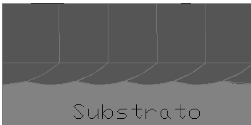
Figura 3.4 – Representação da sobreposição das trilhas formadas por passadas de laser consecutivas.
