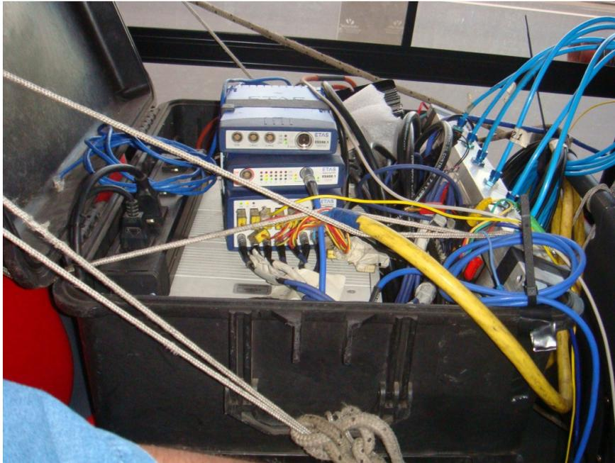
Figura 4. Equipamentos de aquisição posicionados atrás do banco do motorista
