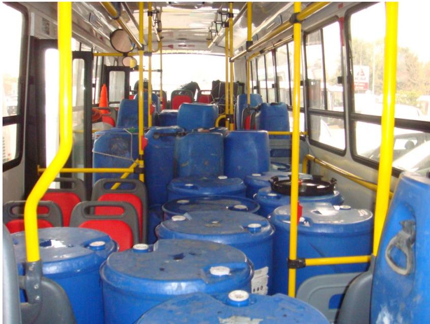
Figura 3. Veículo lastreado com tonéis de água totalizando 15ton de PBT.
