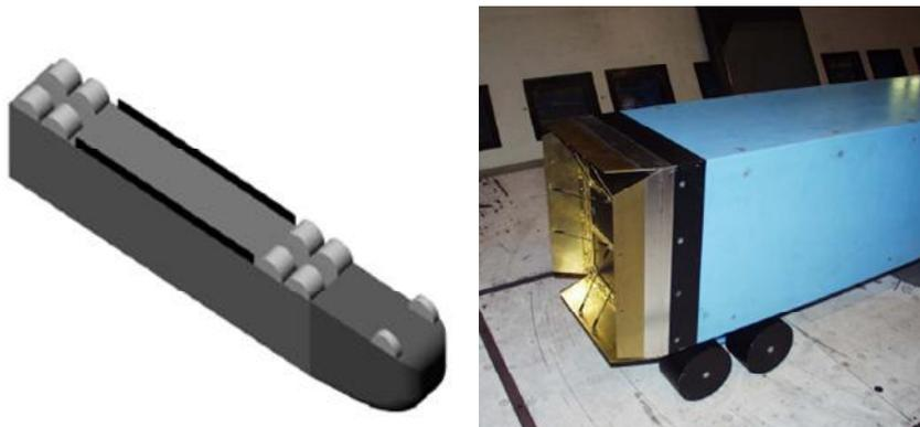
Figura 46. Saia lateral à esquerda e aerofólio traseiro à direita. (Fonte: R.McCallen, SAE 2005)
