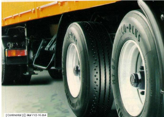
Figura 16. Pneu com a resistência a rolagem otimizada. (Fonte: Continental 2006)
