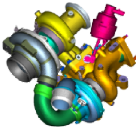
Figura 2.6 – Turbo-compressor de dois estágios
