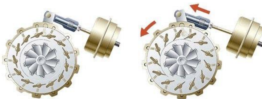
Figura 2.5 – Turbo-compressor de geometria variável com o sistema de pás montada na carcaça central
