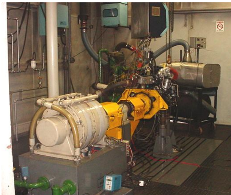
Figura 1.3 - Exemplo de motor instalado em banco de teste
