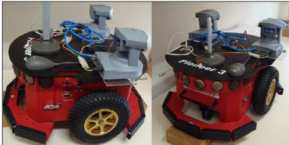
Figura 1.2 Robô Pioneer 3, utilizado para validar os procedimentos de navegação
