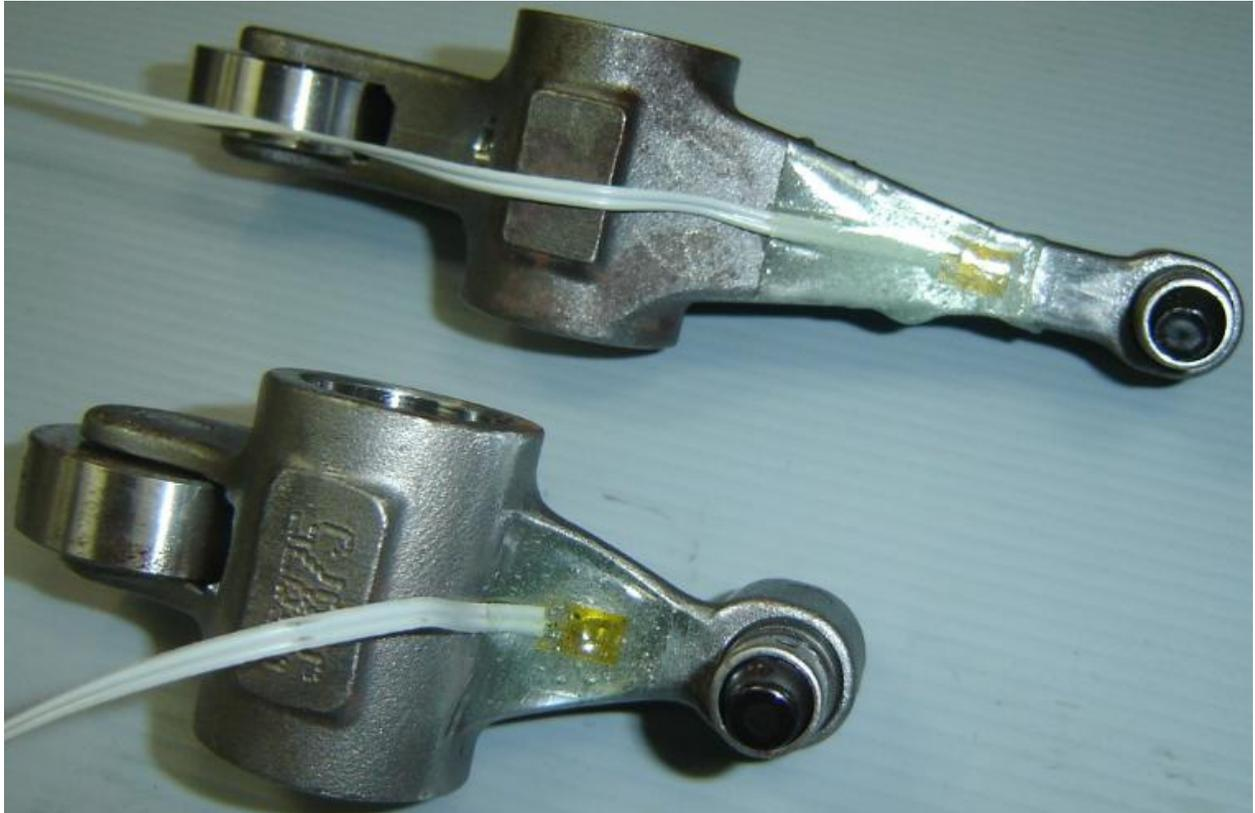
Figura A.6: Extensômetros colados nos balanceiros.
