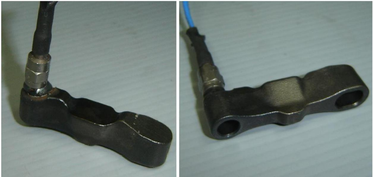
Figura A.2: Fixação do acelerômetro na ponte de válvulas.
