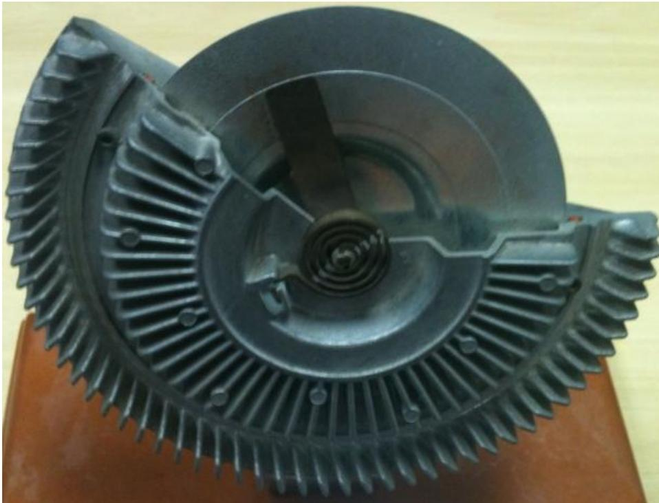
Figura A.11 - Embreagem viscosa do ventilador
