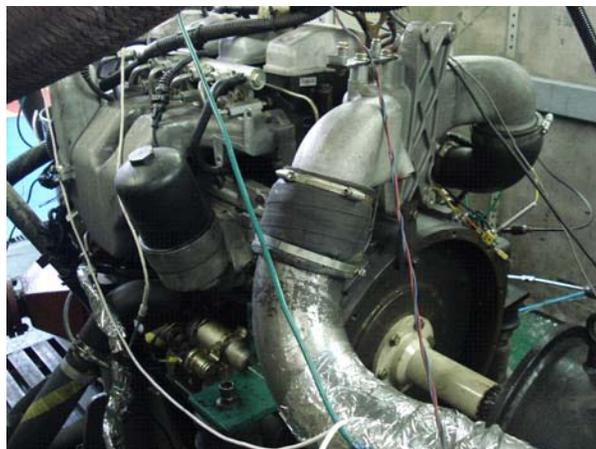
Figura 3.1 – Motor diesel utilizado nos ensaios instalado no banco de teste
