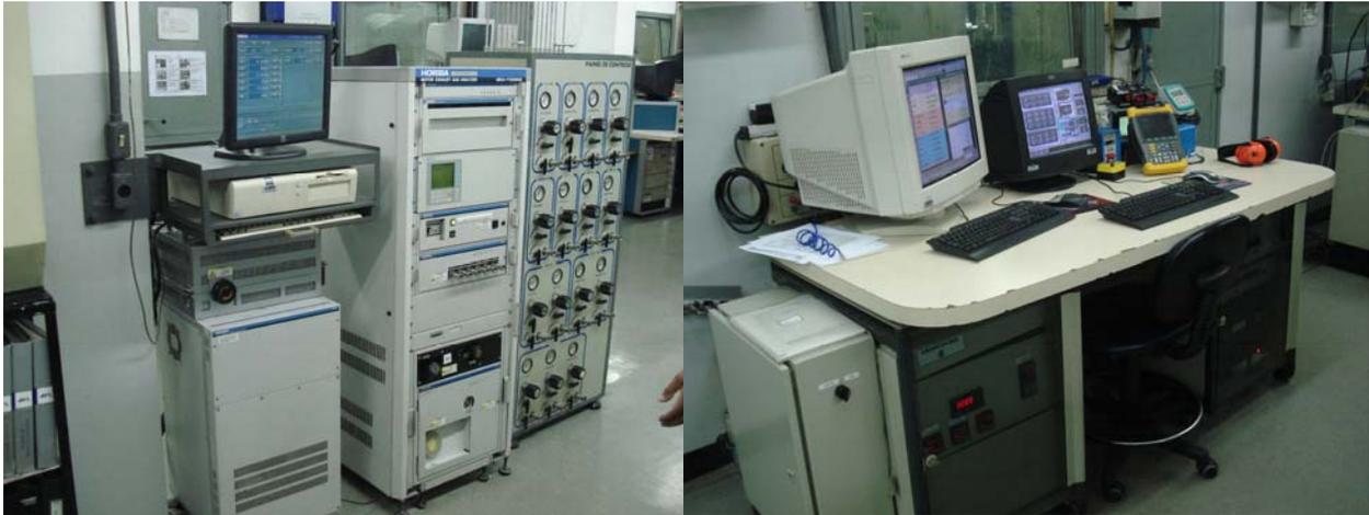
Figura 3.2 – Bancada de emissões Horiba MEXA7100 DEGR utilizada nas medições de CO, CO<sub>2</sub>, HC, NO<sub>x</sub> e O<sub>2</sub> nos ensaios realizados.
