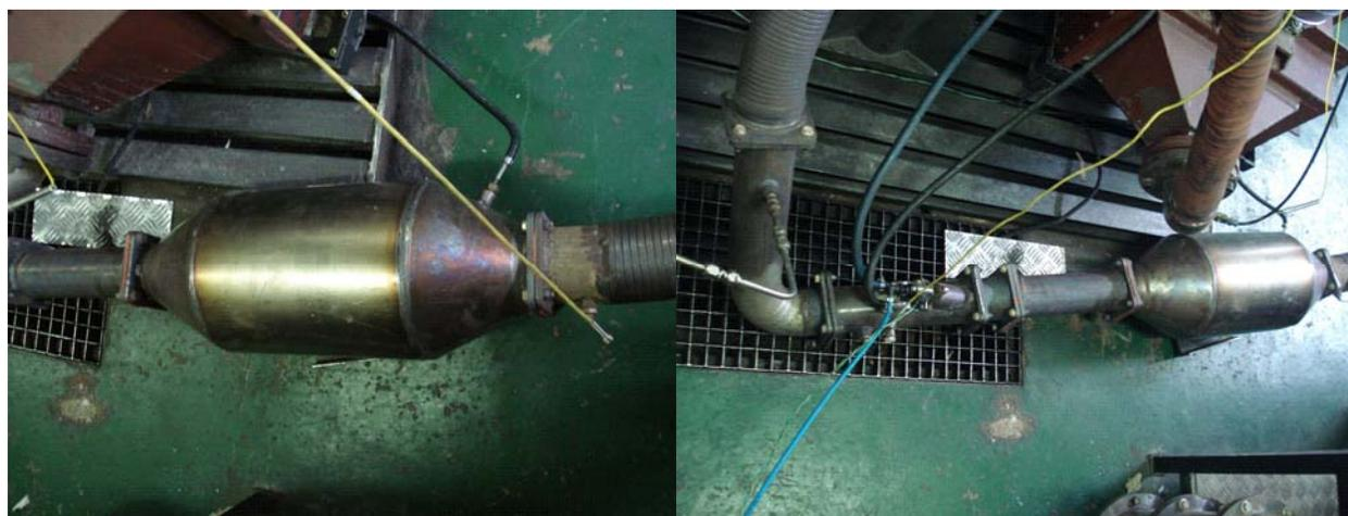
Figura 3.5 – Tubulação de escape, catalisador a base de vanádio e injetor utilizados nos ensaios
