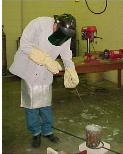
Figura 4.11 – Tomada de temperatura da liga Pb-2,5%Sb com termômetro digital.
