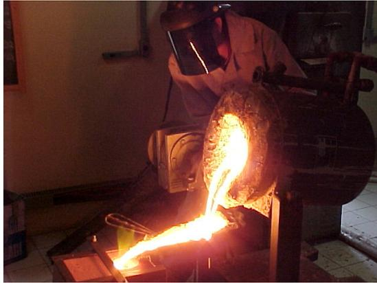
Figura 4.14 – Vazamento do aço líquido em molde de areia.
