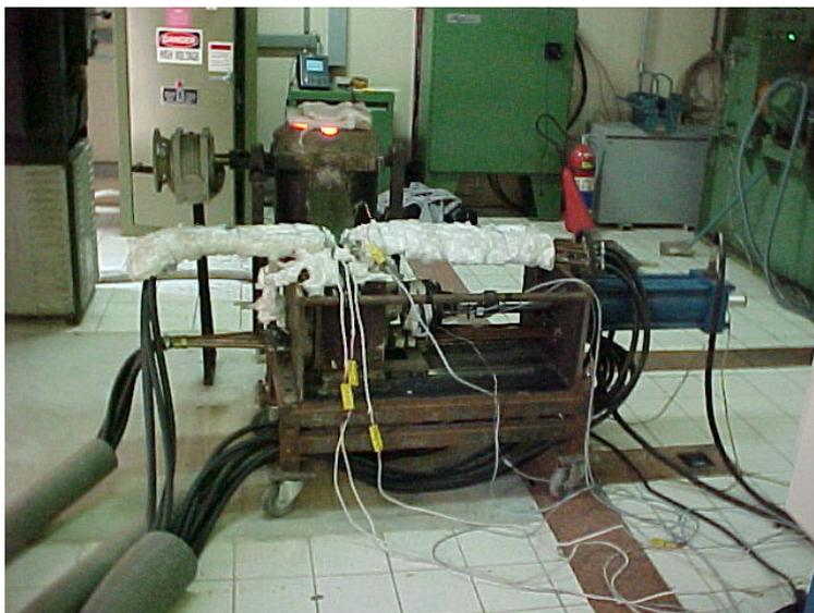
Figura 4.6 – Simulador de Lingotamento Contínuo preparado para o experimento.
