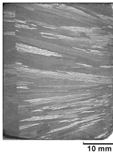
Figura 5.13 – Macroestrutura de solidificação longitudinal da seção inferior de uma placa de Pb-2,5%Sb, obtida em molde refrigerado sem deformação.
