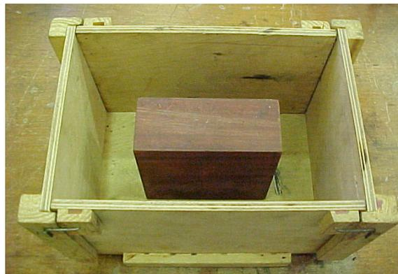
Figura 4.1 – Caixa de moldagem com o macho de madeira.
