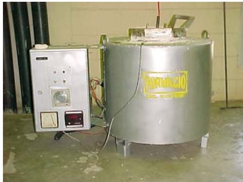
Figura 4.9 – Forno de resistência elétrica tipo cuba.
