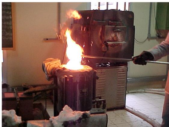
Figura 4.12 – Medição de temperatura no forno elétrico de indução com termopar de imersão.
