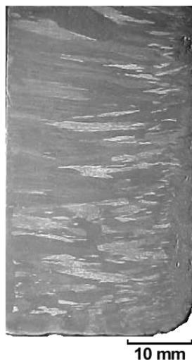
Figura 5.14 – Macroestrutura de solidificação longitudinal da seção inferior de uma placa de Pb-2,5%Sb, obtida em molde refrigerado com deformação de 10 mm.
