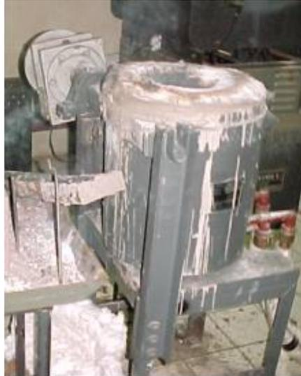
Figura 4.10 – Forno elétrico de indução.
