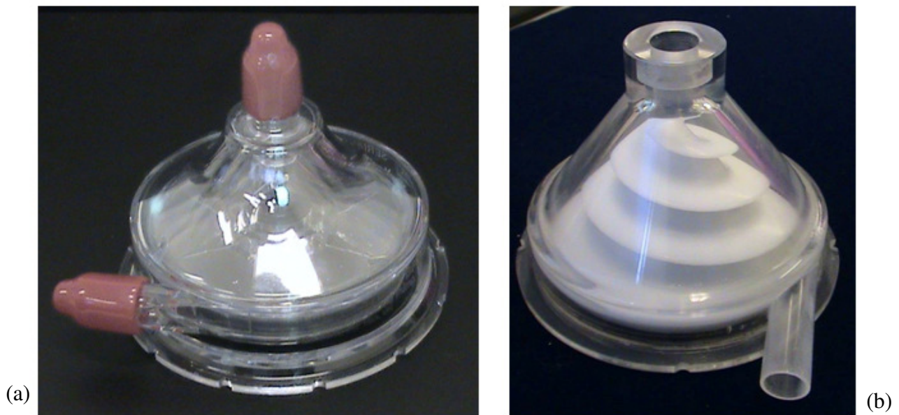
Figura 3.12 (a) Bomba já comercializada e (b) Bomba Espiral usinada.
