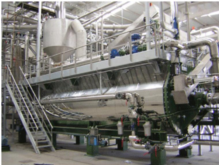
Figura 2.2.1: Digestores utilizados para cozimento dos resíduos (HAARSLEV INDUSTRIES, 2009)
