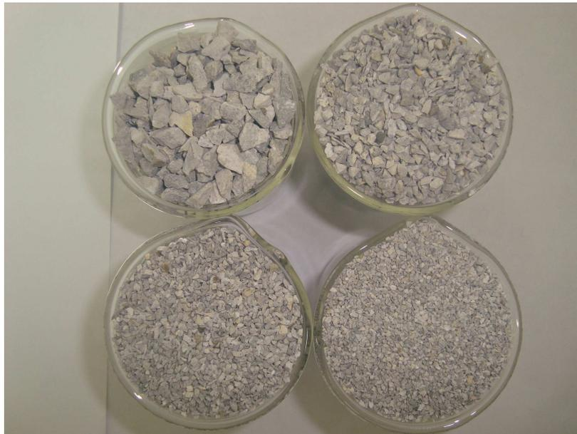
Figura 5.4: Fotografia das quatro granulometrias utilizadas.
