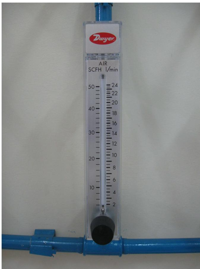
Figura 4.18: Detalhe do rotâmetro instalado na linha de ar comprimido.
