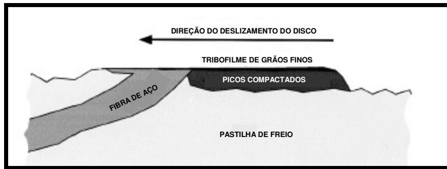
Figura 2.11 – Seção transversal da pastilha mostrando seus componentes (ERIKSSON e JACOBSON, 2000)
