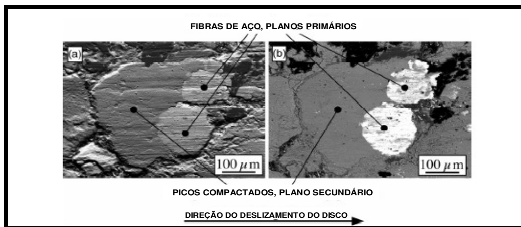
Figura 2.9 – Contato dos planos na pastilha de freio orgânica (ERIKSSON e JACOBSON, 2000)
