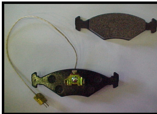
Figura 3.6 – Termopar instalado na pastilha interna
