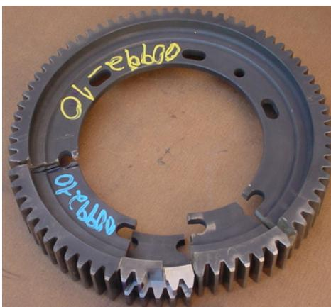
Figura 3.5 – Cortes efetuados nas engrenagens para a preparação metalográfica.
