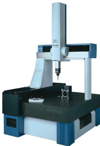
Figura 3.29 – Máquina tridimensional utilizada nas medições com software Geopack da empresa Usicomp.
