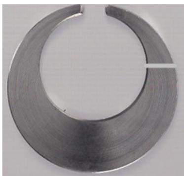
Figura 3.6 – Corte efetuado nos corpos de prova Navy “C” para a preparação metalográfica.
