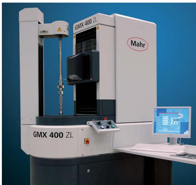
Figura 3.30 – Máquina medidora de engrenagens da empresa Eacial.
