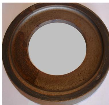
Figura 3.10 – Engrenagem forjada de aço 4140 antes do tratamento térmico 1 (TT1).
