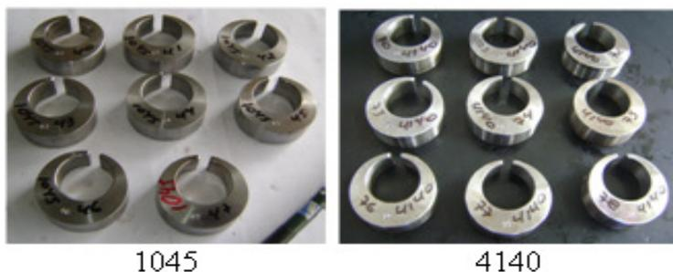
Figura 3.20 - Corpos de prova Navy “C” dos aços 1045 e 4140, antes da têmpera e revenimento (TT2).
