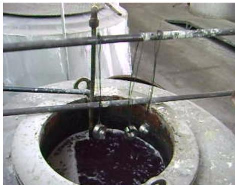
Figura 3.23 - Corpos de prova Navy “C” sendo colocados no banho de nitretação líquida.
