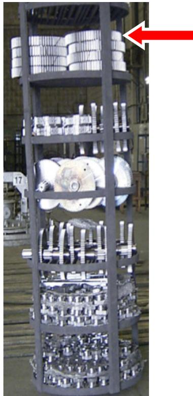
Figura 3.25 - Disposição da engrenagem de aço 4140 na carga do forno de nitretação gasosa.
