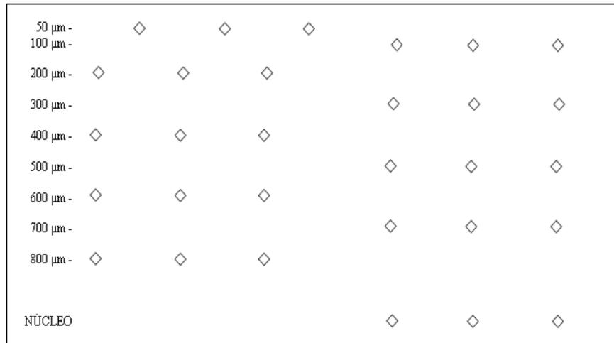
Figura 3.31 – Distância entre as impressões Vickers para as medidas de microdureza.
