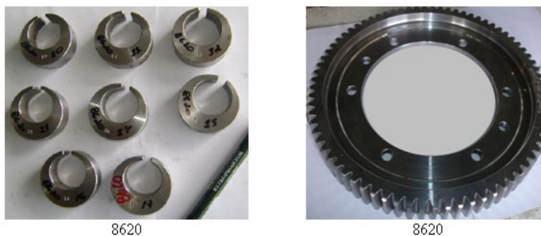
Figura 3.19 - Corpos de prova Navy “C” e engrenagem de aço 8620 antes do processo de cementação.
