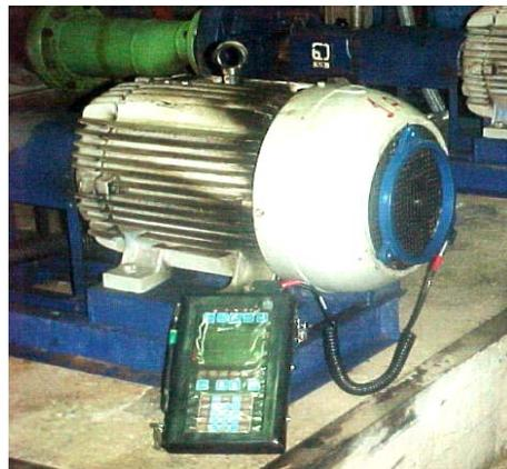
Figura 4. 19 - Medição em campo com a bobina CSI.
