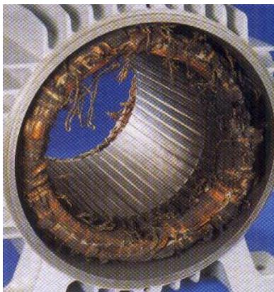
Figura 3. 16 - Queima por sobrecarga, subtensões ou sobretensões.
