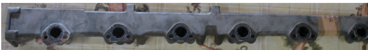
Figura 2.17.1 – Tubulação de água lado cabeçote do motor
