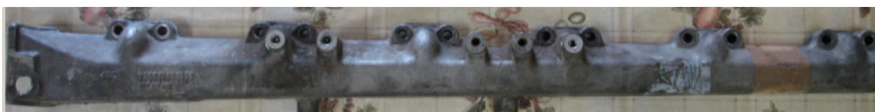
Figura 2.17.3 – Tubulação de água lado veículo
