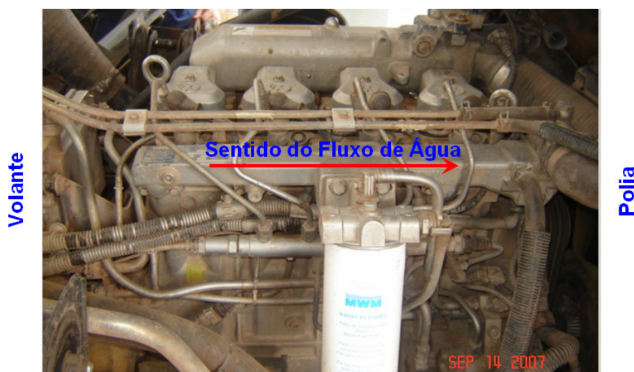
Figura 2.4 – Tubulação de água (MWM, 2009).
