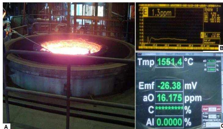
Figura 2.14: A) Tanque de vácuo, B) Medição de hidrogênio, C) Medição de oxigênio. Fotos gentilmente cedidas pela MWL Brasil.
