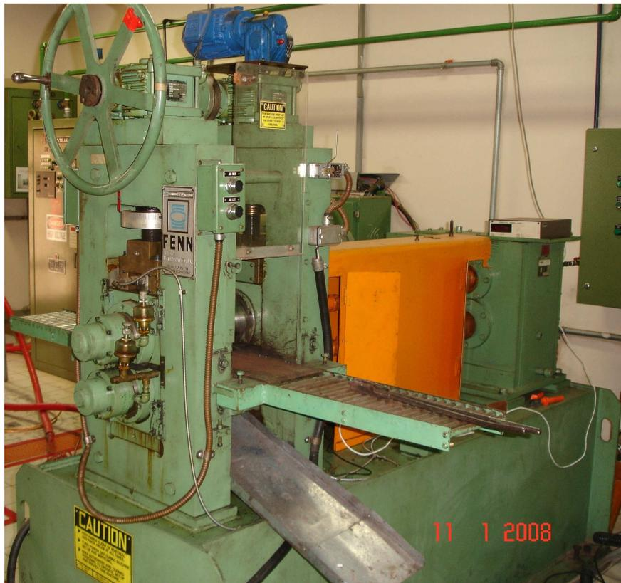
Figura 3.5: Laminador FENN-051, usado nos ensaios de laminação no Laboratório de Tratamentos Termomecânicos do DEMA – Unicamp.
