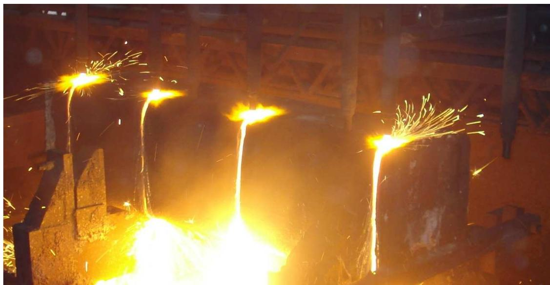
Figura 2.16: Corte do lingote. Foto gentilmente cedida pela MWL Brasil.
