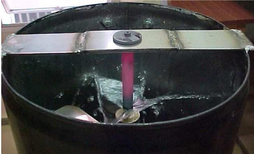
Figura 3.15: Ensaio Jominy dos aços C7 e C7Nb.
