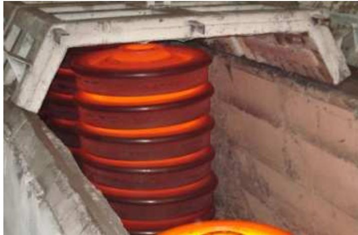
Figura 2.23: Fossa de resfriamento das rodas forjadas. Foto gentilmente cedida pela MWL Brasil.
