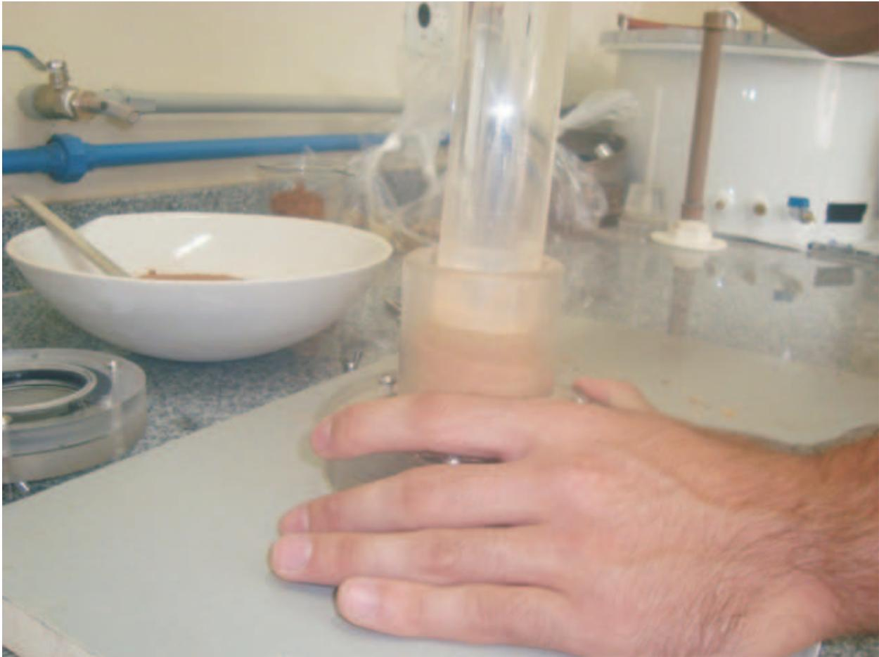
Figura 4.7: Fotografia do enchimento da coluna.
