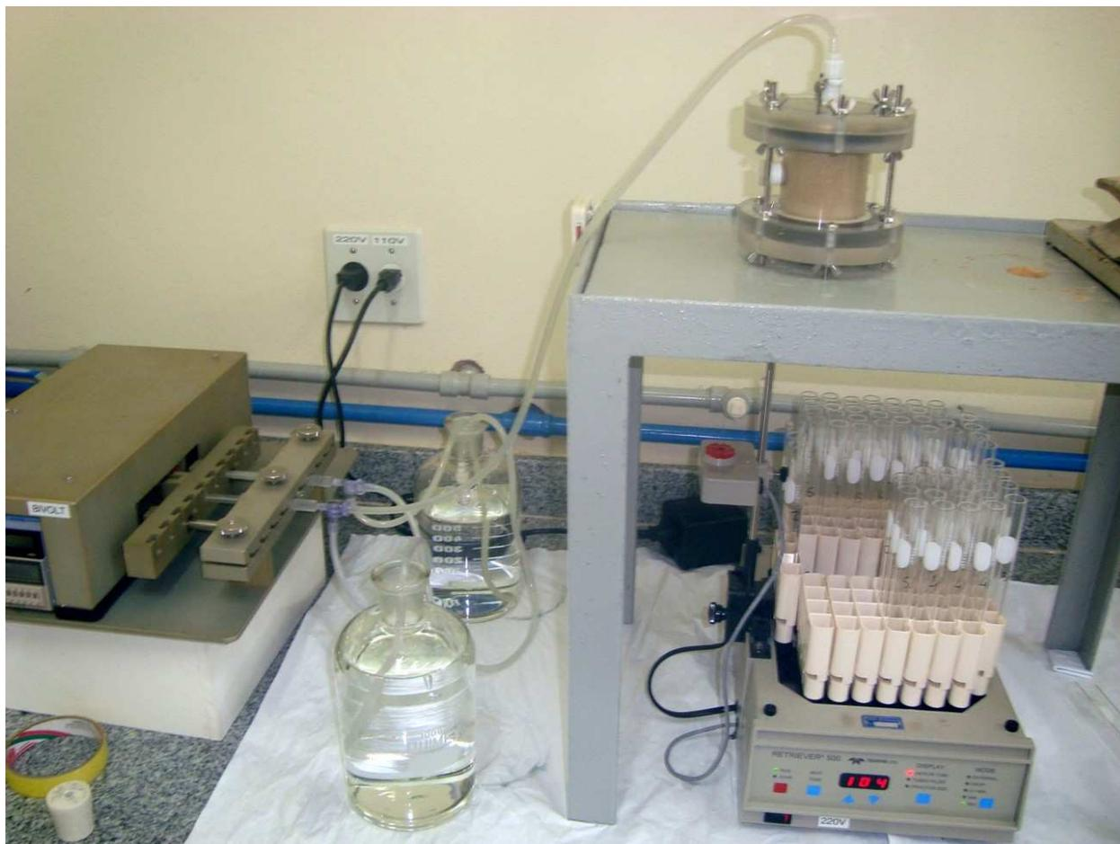
Figura 4.3: Fotografia do experimento de lixiviação em coluna.
