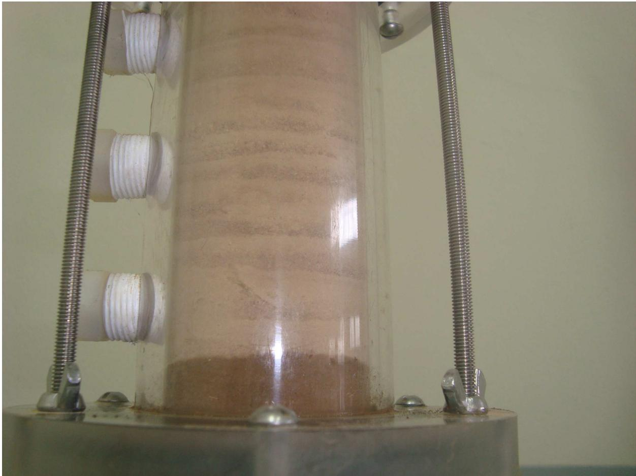
Figura 4.9: Fotografia do procedimento de saturação da coluna.
