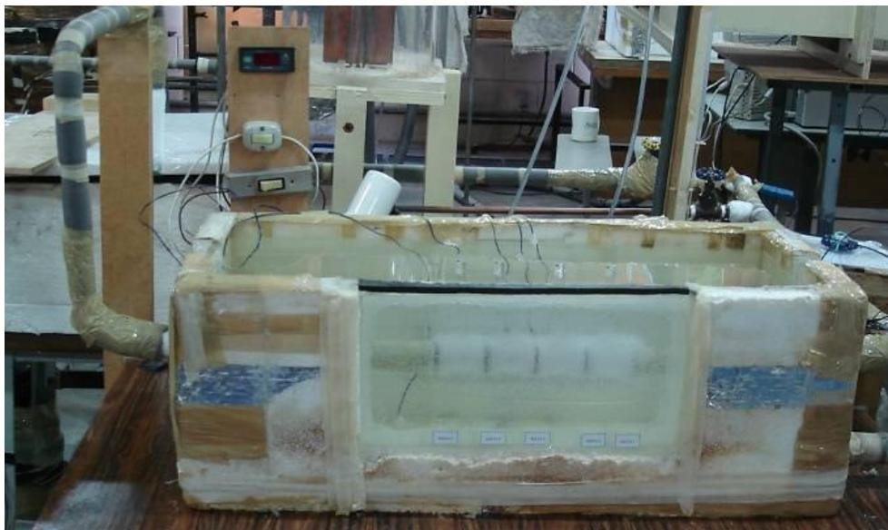
Figura 3. 2 – Montagem da seção de testes 700x240x235mm.
