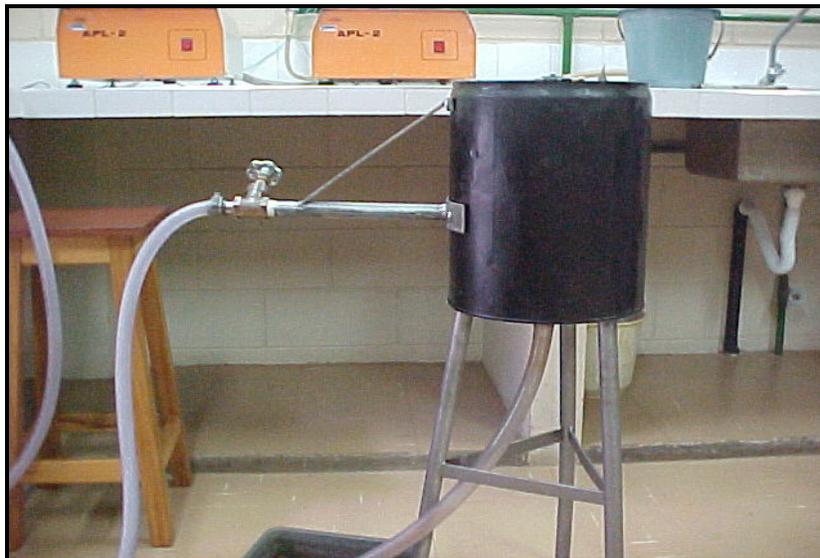
Figura 3.6: Dispositivo para o ensaio Jominy.
