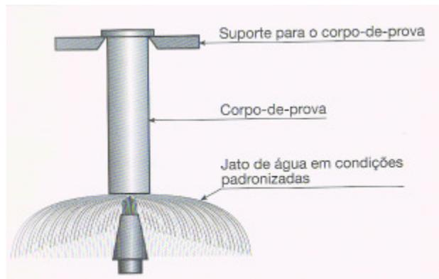
Figura 3.5: Esquema do ensaio temperabilidade Jominy (Colpaert, 2008).
