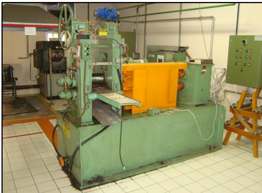
Figura 3.2: Laminador FENN-051, para os ensaios de laminação no Laboratório de Tratamentos Termomecânicos do DEMA – Unicamp.
