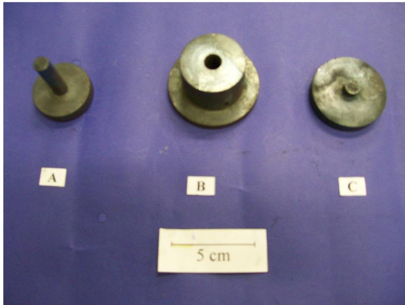
Figura 5 – Imagem do molde de Aço para construção do EDG: (A) pulsão, (B) corpo do molde e (C) suporte do EDG
