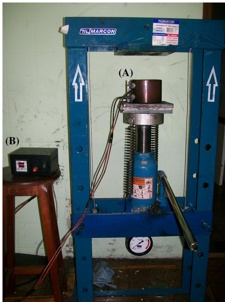
Figura 6 – Imagem da Prensa hidráulica: (A) Forno e (B) controladora de temperatura
