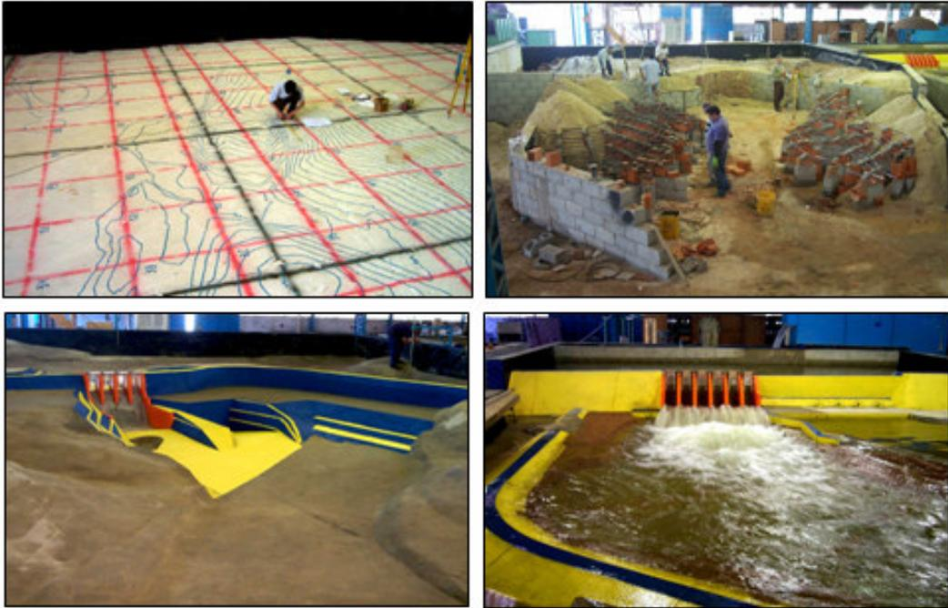
Figura 3.5 – Fases da construção de modelo tridimensional.
