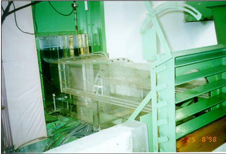
Figura 3.10 – Vista lateral do modelo reduzido do túnel de desvio.
