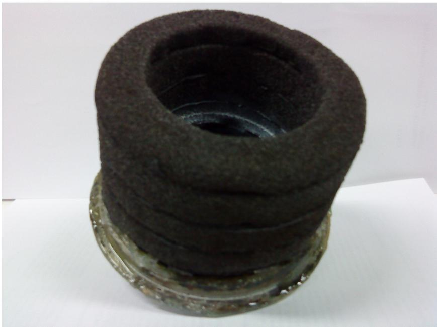
Figura 4.5: Ilustração da montagem rotor e meio poroso.
