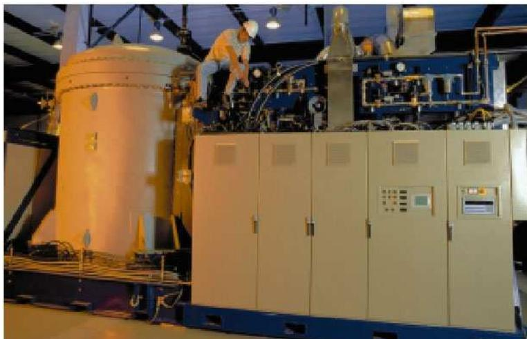
Figura 2.6: Unidade estacionária SOFC de 220 kW da Siemens.
