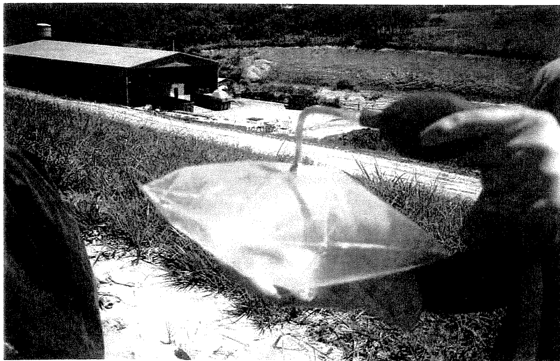
Figura 4.6. Detalhe do enchimento do “bag” com biogás coletado
