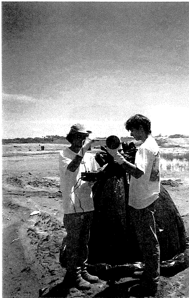
Figura 4.3. Medição da velocidade de saída do biogás no dreno nº 53
