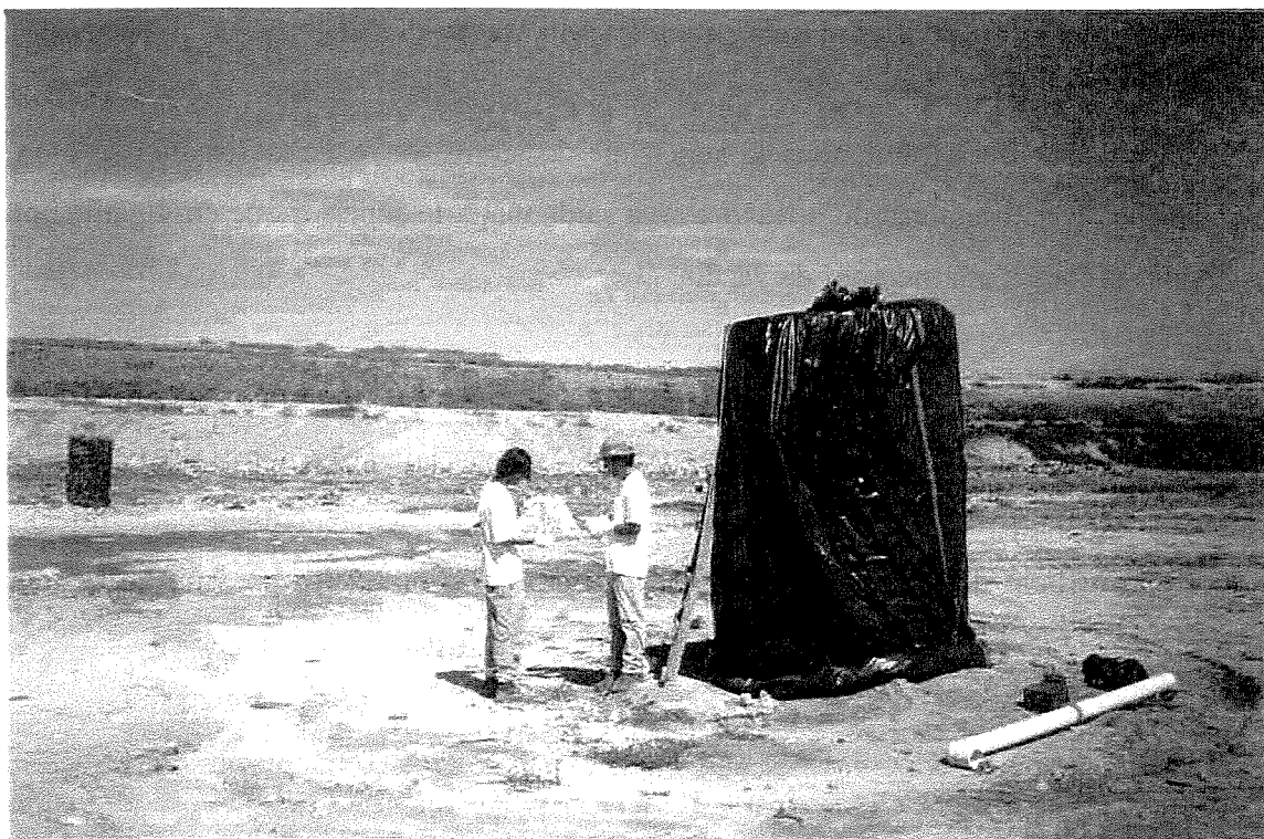
Figura 4.5. Coleta de biogás no dreno nº 54
