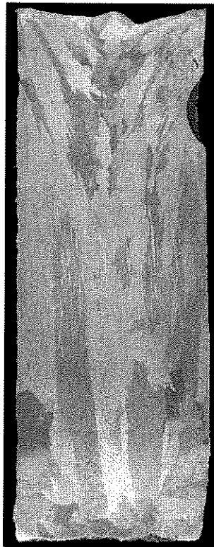
Figura 4.10. Macroestrutura da liga Al5%Cu para a solidificação vertical descendente com molde polido.
