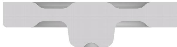
**Figura 2.8** – Secção transversal de um forjado sem formação de espelho.
