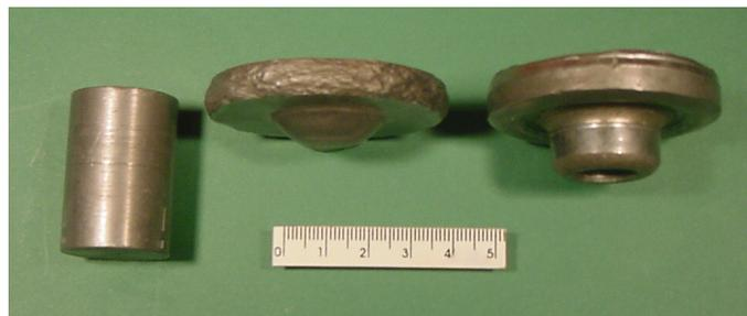
**Figura A.3.2** – Tarugos, pré-formas e forjados de alumínio comercial obtidos em ensaios de forjamento à temperatura de 400 °C.
