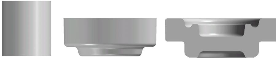
**Figura 5.9** – Exemplo de um tarugo e pré-forma para obtenção do forjado 12.
