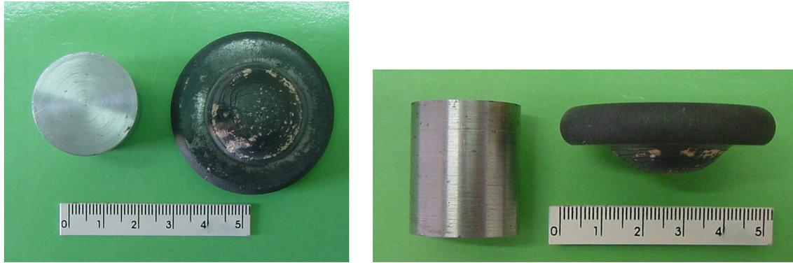
**Figura A.3.3** – Tarugos e pré-formas de aço obtidas em ensaios de forjamento à temperatura de 1000 °C.
