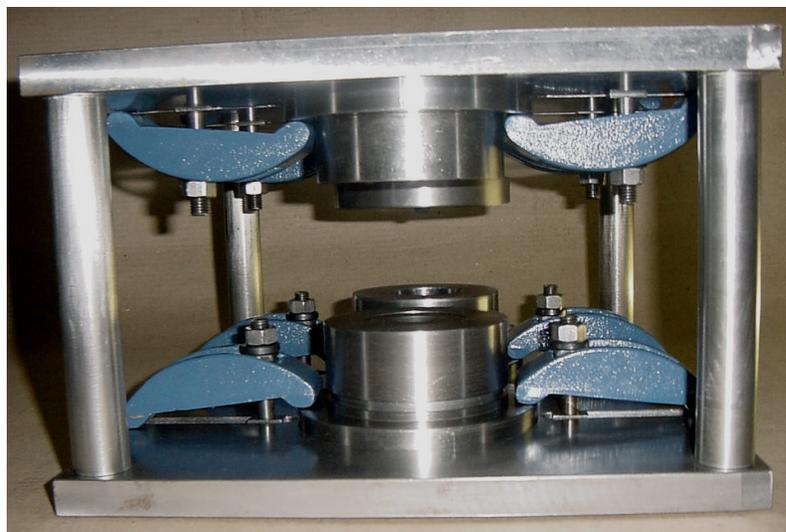
**Figura 5.19** - Dispositivo de troca rápida de matrizes montado.
