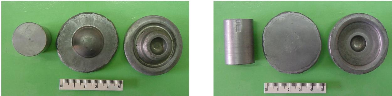
**Figura A.3.1** – Tarugos, pré-formas e forjados de chumbo comercial obtidos em ensaios de forjamento à temperatura ambiente.
