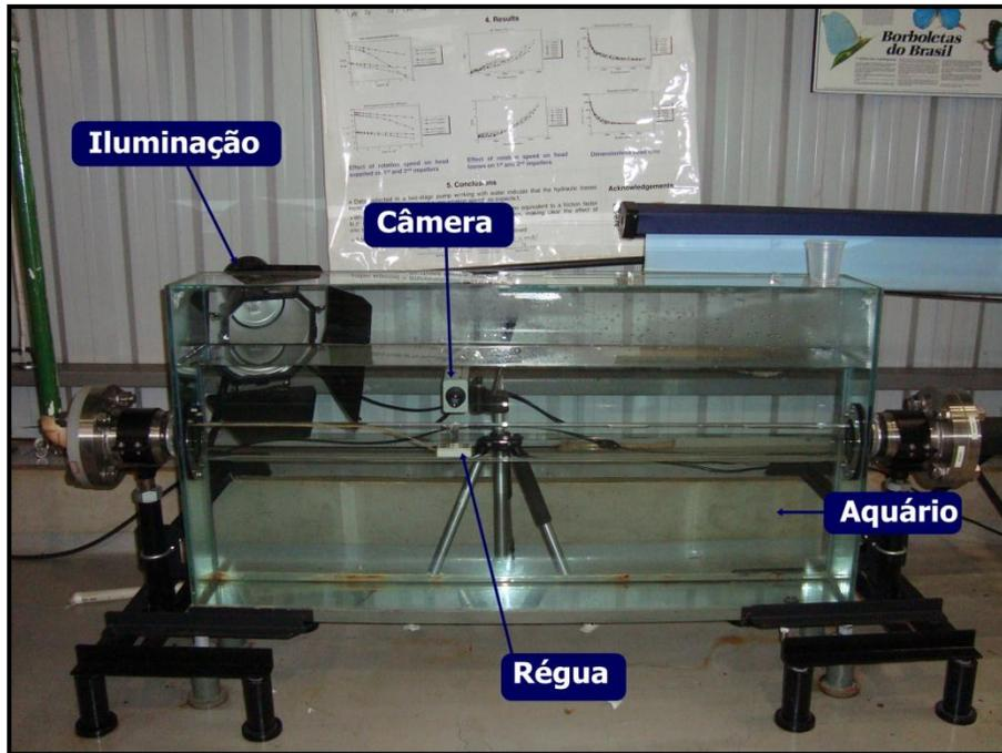
Figura 4.20 Aquário utilizado para a correção da luz na imagem.
