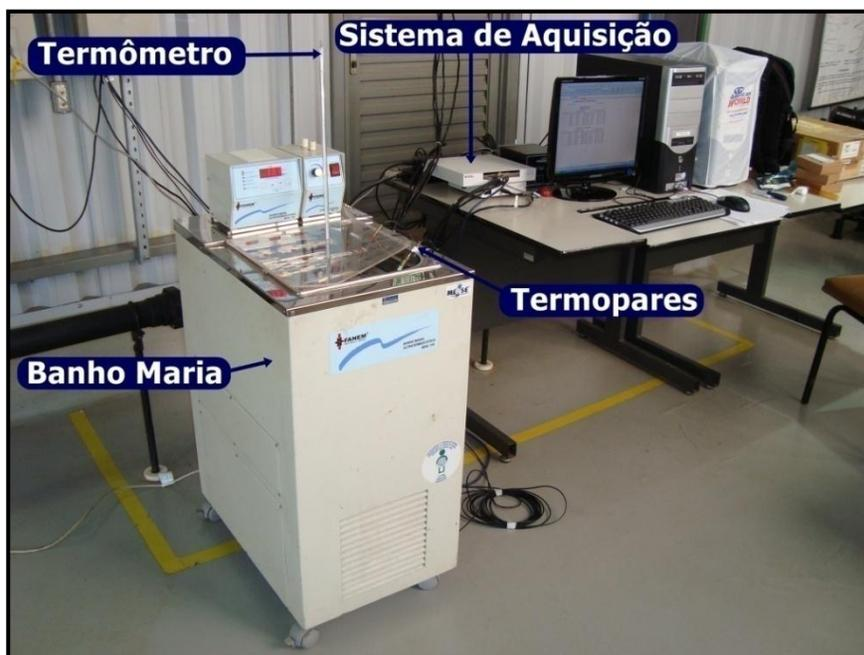
Figura 6.3 Equipamentos para calibração dos termopares.
