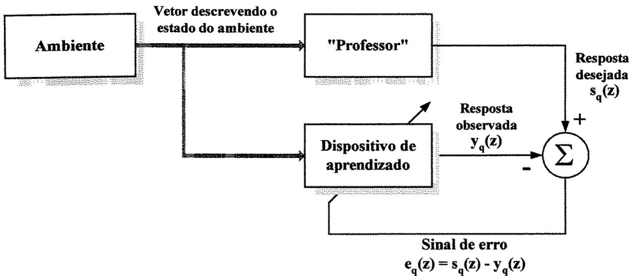
Figura 3.03 - Diagrama de blocos de um sistema com aprendizado supervisionado.
