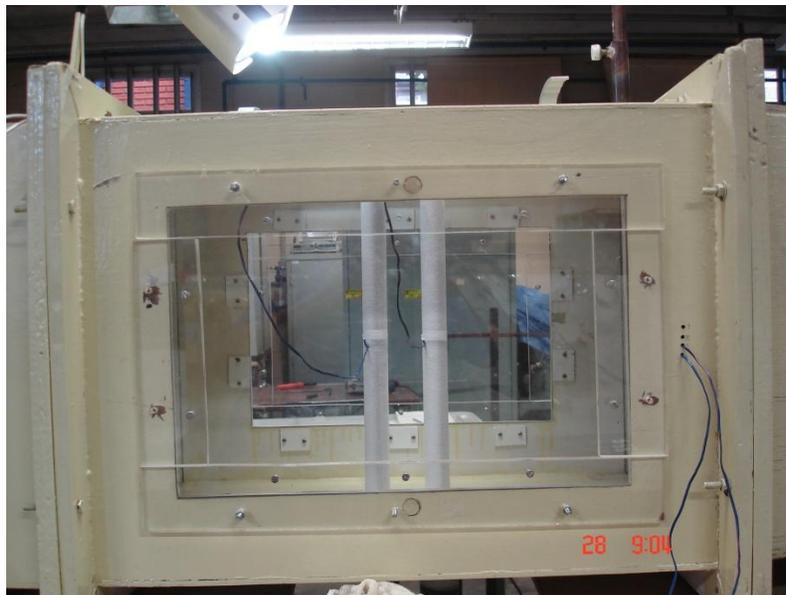
Figura 3.3 Seção de teste do túnel de vento.
