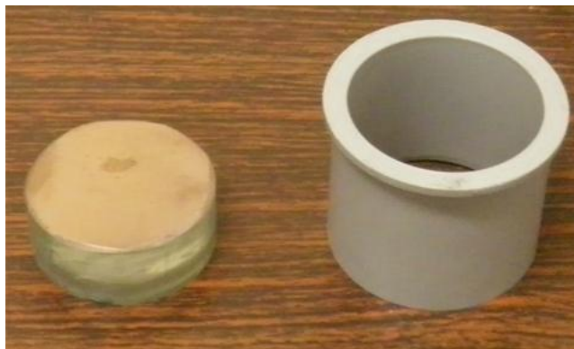
Figura 3.10: Pastilha de resina epóxi com a amostra embutida (esquerda) e matriz usada na conformação do embutimento. A cor dourada sobre a superfície é consequência do recobrimento da pintura em base ouro
