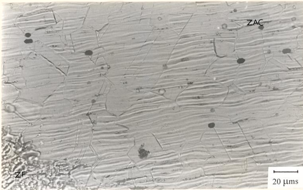
FIG 46 - Micrografia da região de crescimento dos grãos. Observa-se pites profundos e não profundos produto do ensaio de corrosão intergranular. Junta soldada com metal de adição ER 316L e IC de 0,49 kJ/mm. Ataque eletrolítico com Persulfato de Amônia.
