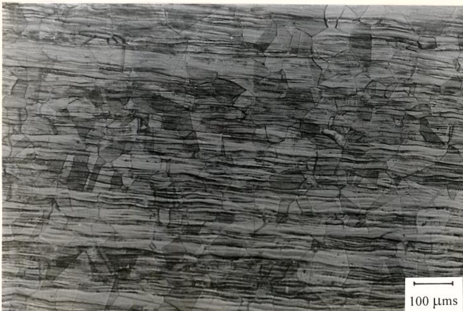
FIGURA 36 - Micrografia do metal base antes da de soldagem. Microestrutura de austenita monofásica e linhas características do processo de laminação do material. Ataque eletrolítico com Ácido Oxálico 10%.
