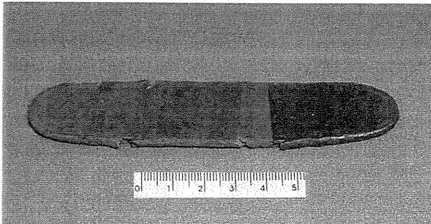
Figura 4.10 – Produto final obtido após a laminação a quente
