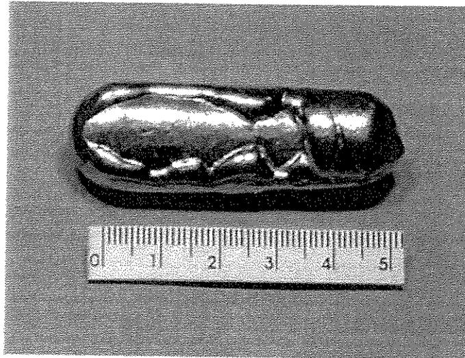
Figura 4.1 – Fotografia das irregularidades presentes na parte inferior da amostra fundida
