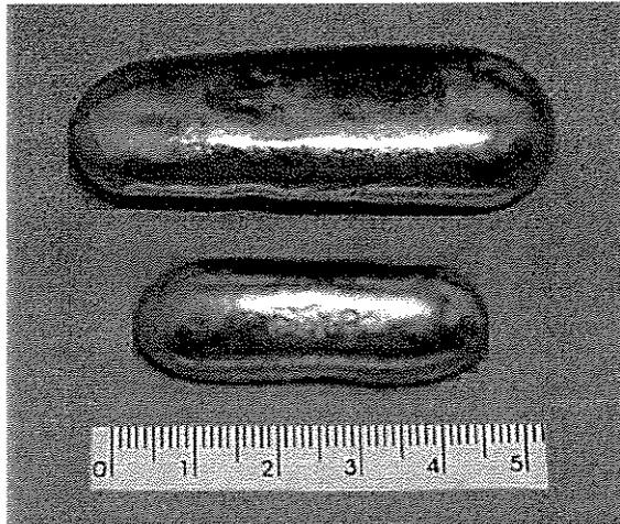
Figura 3.3 – Lingotes de 15 g (abaixo) e 45 g (acima) obtidos no forno a arco
