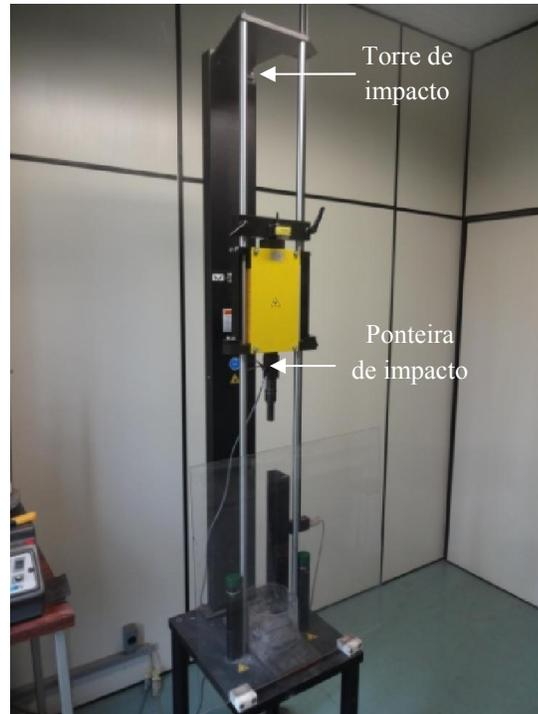
Figura 3.18: Equipamento tipo *drop-test* utilizado nos ensaios de impacto, com torre e ponteira de impacto.
