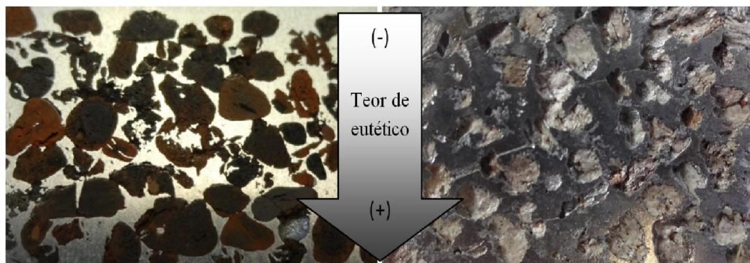
Figura 4.14: Indicação da variação do teor de eutético em um corte longitudinal de peças dos compósitos AA7075 / cinasta e AA7975 / vermiculita no estado tixoconformado.
