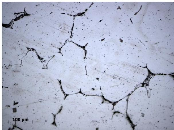
Figura 4.23: Microestrutura típica do compósito AA7075 / cinasita, após solubilização – região central (seção B) da amostra. (MO).
