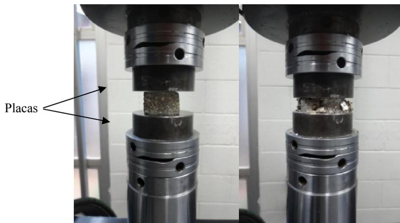
Figura 3.17: Teste de compressão semi-estática, com placas paralelas e amostras com laterais livres, nos compósitos produzidos: (a) início do ensaio; (b) final do ensaio, com colapso da amostra.
