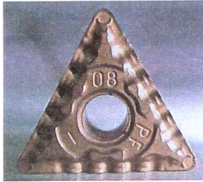
Figura 4.3: Pastilha de metal duro utilizada nos ensaios
