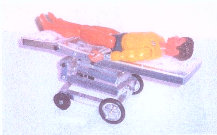
Fig. 4.9 – Pré-protótipo na posição deitado com inclinação lateral.
