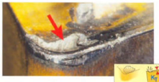
Figura 2.17 - Desgaste de cratera (SANDVIK, 2002)
