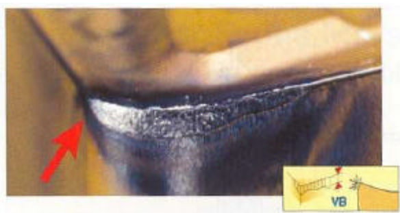
Figura 2.16- Desgaste de flanco (SANDVIK, 2002)
