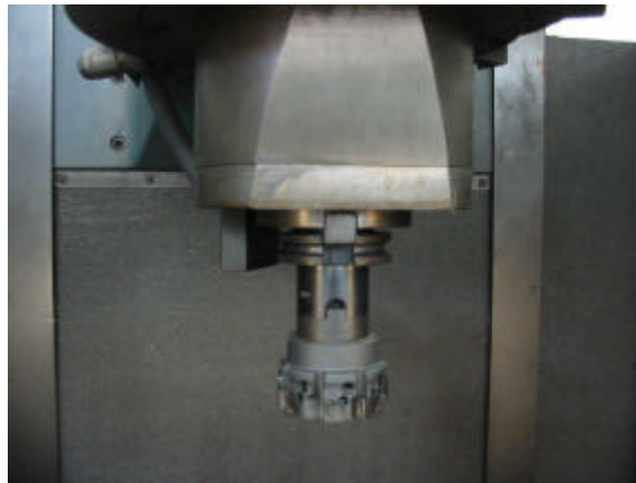
Figura 3.15 - Cabeçote de fresar montado no eixo-árvore
