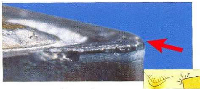
Figura 2.20 - Deformação plástica da aresta de corte (SANDVIK, 2002)
