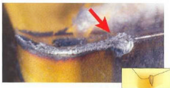
Figura 2.18 - Desgaste de entalhe (SANDVIK, 2002)
