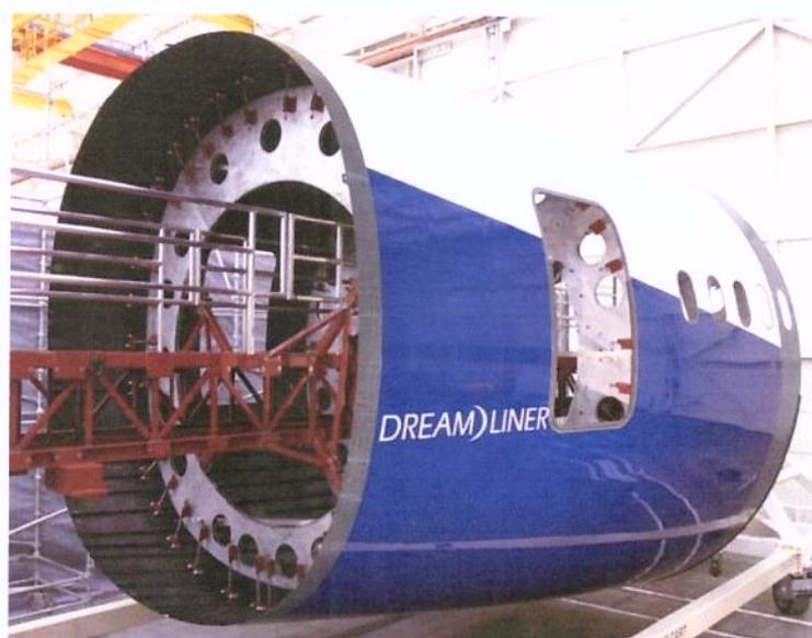
Figura 1.1: Primeira seção de fuselagem de jato comercial a ser fabricada com material compósito. Crédito: The Boeing Company.
