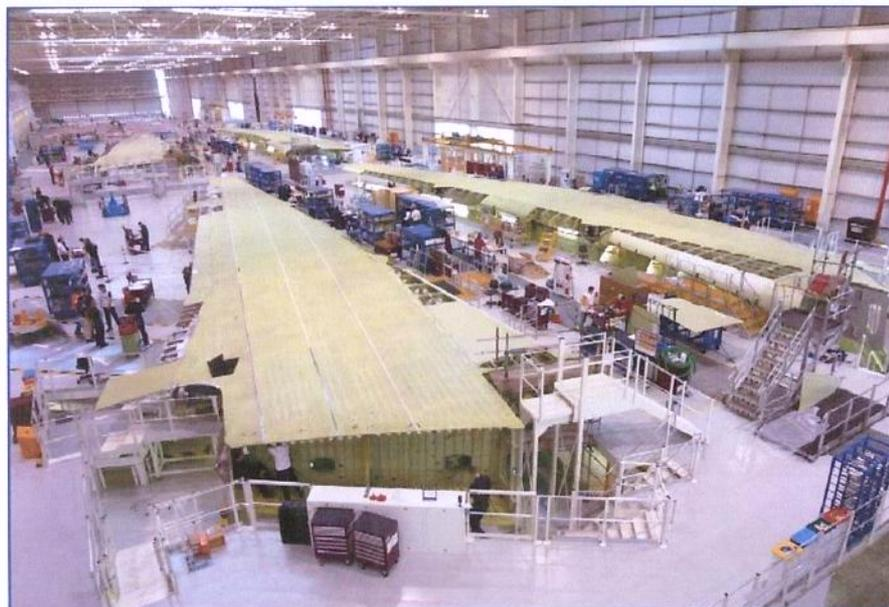
Figura 2.2: Asa do A380 em fabricação pela Airbus UK. Crédito: Reinforced Plastics Abril-2004
