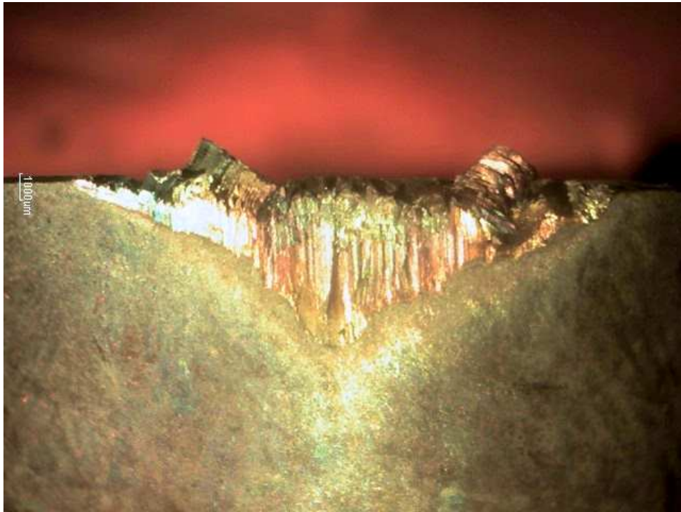
Figura 4. 1 – Típico desgaste de flanco observado no ensaio 1
