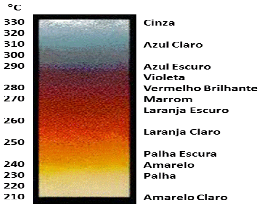
Figura 4. 12 – Coloração x Temperaturas do aço inoxidável martensítico (Associação Portuguesa de Bushcraft, 2002)
