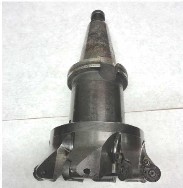
Figura 3. 5 – Conjunto de insertos, porta ferramenta e mandril.
