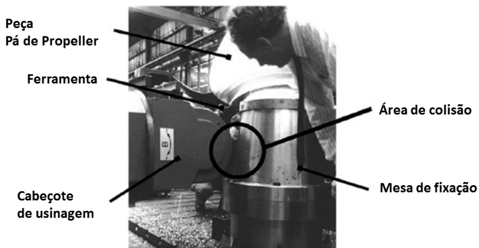
Figura 2. 13 – Colisão em pá de turbina do tipo Propeller (LAUWERS, DEJONGHE e KRUTH, 2003)
