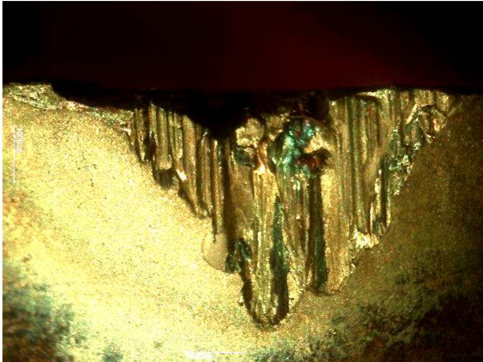
Figura 4. 8 – Típico desgaste de flanco observado no ensaio 8
